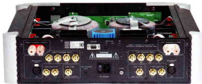
Moons 700i besitzt getrennte Anschlussfelder für Rechts und Links – mit echten XLR-Eingängen, Tape-In/Outs und Vorverstärker-Ausgängen. Dazu kommen Fernsteuer- und Schaltspannungsbuchsen.
