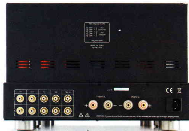
Der Unison S 9 bringt vier von Relais angewählte Line-Eingänge mit und einen Aufnahmeausgang. Im Kasten darüber befinden sich der Netztrafo und die Hochvolt-Elkos.
