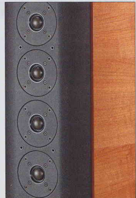
Die vier Hochtöner auf der Rückseite strahlen vor allem horizontal ab, was Boden und Deckenreflexionen vermeidet
